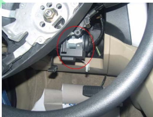
图 3.4 拆卸防盗控制器用线圈总成时方向盘位置
